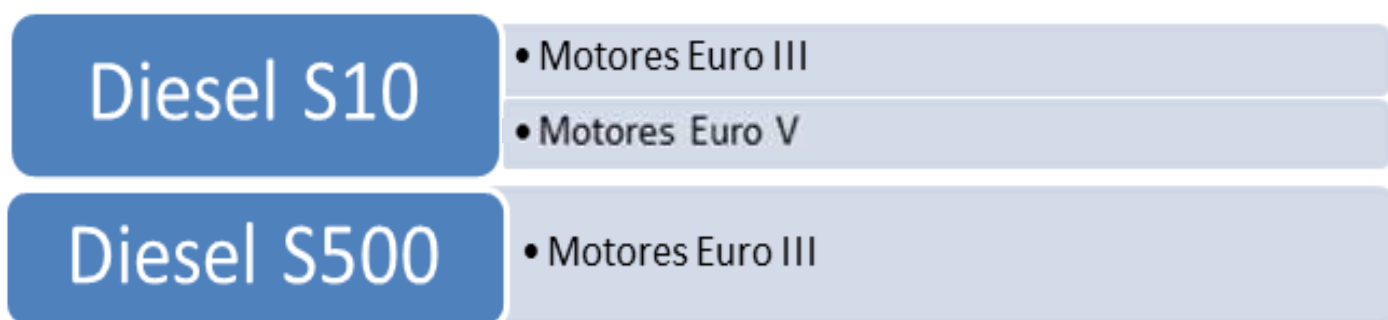
Figura 16 - Esquematização dos tipos de combustíveis adequados para cada tipo de
